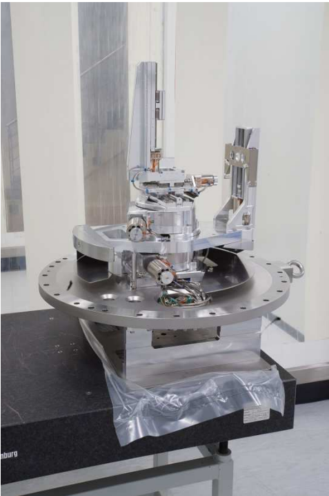
图 1 用于光谱学的多轴定位，在位于埃斯克巴克的符合 ISO 7 级的无尘室中制造
